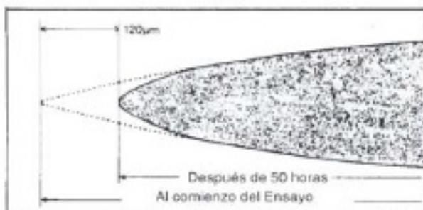
*Ensayo de Resistencia de Desgaste con una Aguja DP*
